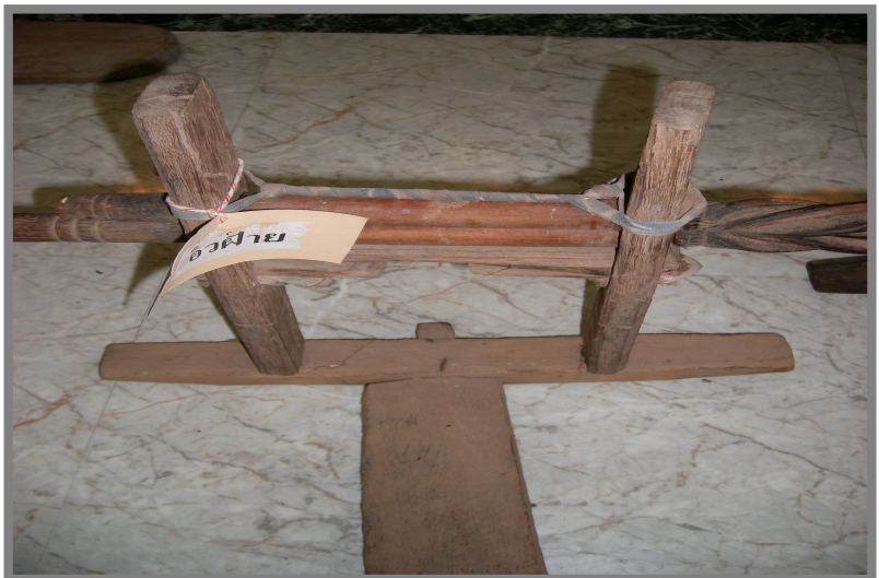
อ้าวฝ้าย เครื่องมือสำหรับปั่นหลอดสำหรับสาวไหมให้เป็นเส้น
