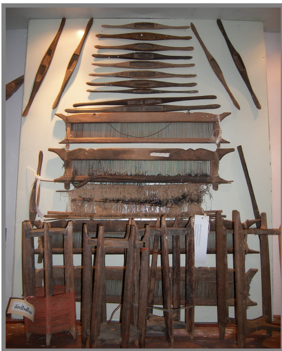
กระสวย ไม้ใส่เส้นไหมสำหรับทอผ้า ใช้ประกอบกับฟืมทอผ้า
