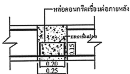
ทาบเหล็ก 0.20 ม. งอขอมมาตรฐาน 90° ความยาว 0.15 ม. เชื่อมปลายยึดด้วยเหล็ก DB 12 แบบขยายรายละเอียดรอยต่อ B6
