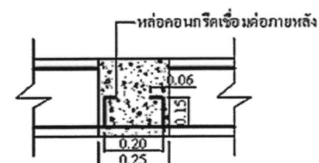
ทาบเหล็ก 0.20 m. งอข้อลักษณะแบบ J-Shape แบบขยายรายละเอียดรอยต่อ B5
