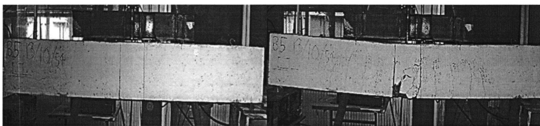
ภาพที่ 4.9 ลักษณะคานก่อนการวิบัติและหลังการวิบัติของคานตัวอย่าง B5
