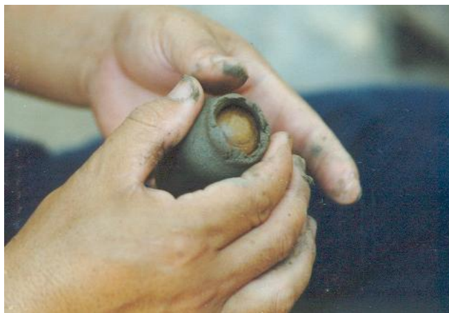
รูปที่ ๘๙ การโอบเฟ็ด คือ การนำดินที่ได้จากการกลึงแต่งหุ่นมาร้อนให้ได้เม็ดละเอียด แล้วนำมาผสมน้ำคลุกให้เข้ากันดี จึงนำมาหุ้มขี้ผึ้งที่พิมพ์ลายและติดชนวนแล้ว
