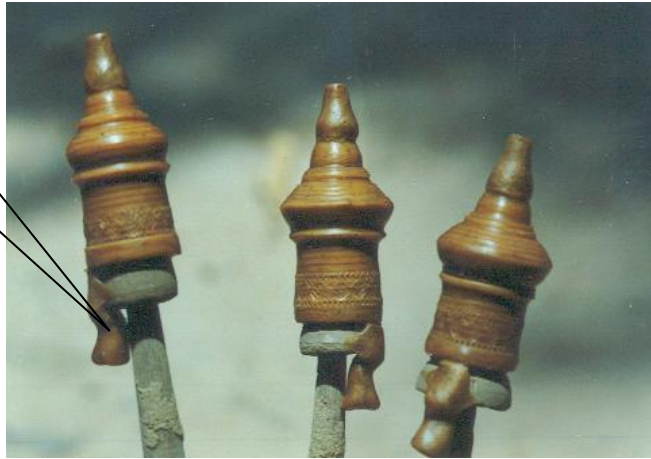
รูปที่ ๘๘ การติดชนวน เพื่อทำเป็นรูเททองเหลือง ให้น้ำโลหะไหลผ่านเข้าเป้า
