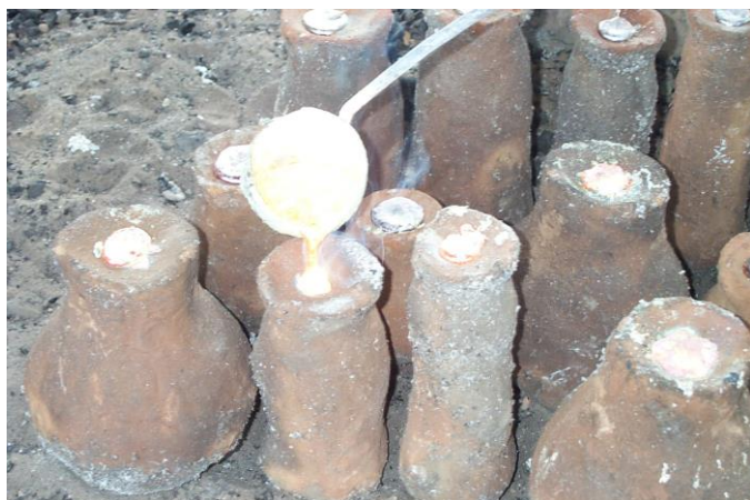
รูปที่ ๔๕ เมื่อโลหะหลอมเหลวและอุณหภูมิได้ที่ ตักด้วยช้อนตักเทลงในเบ้า ในขณะที่เบ้ายังร้อนอยู่
