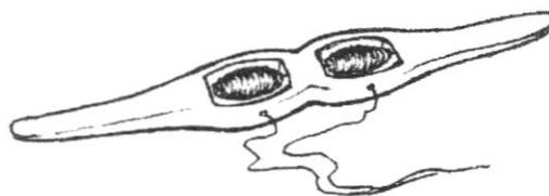
ภาพที่ 3-26 กระสวยแบบเรือ 1 หลอดและกระสวยแบบเรือ 2 หลอดหรือแกนคู่
