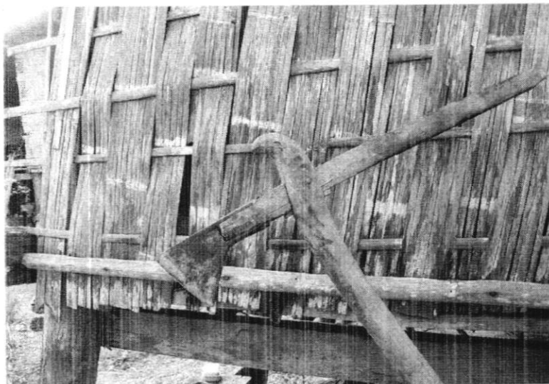
ชวานหงอนใช้ถากเสาะและไม้ โครงสร้างรวมทั้งพื้นปูนเรือน
