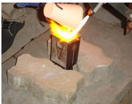
รูปที่ 3.28 การเทแก้วเหลวจากเบ้าลงแบบพิมพ์โดยใช้หัวเป่าฟั่นให้ความร้อน
