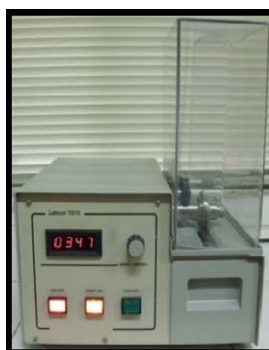
รูปที่ 3.13 เครื่องตัด ยีห้อ Benetec limited ( Labcut 1010 ) ภาควิชาฟิสิกส์ คณะวิทยาศาสตร์ มหาวิทยาลัยอุบลราชธานี
