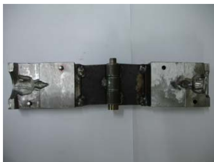
รูปที่ 3.8 แบบพิมพ์ด้านในสำหรับหล่อพระแก้วไพฑูรย์
