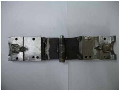
รูปที่ 3.11 แบบพิมพ์ด้านในสำหรับหล่อพระแก้วบุษราคัม
