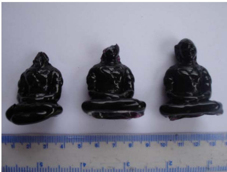
รูปที่ ก.2 การนำองค์พระพุทธรูปเข้าเตาอบซ้ำเกินไป
