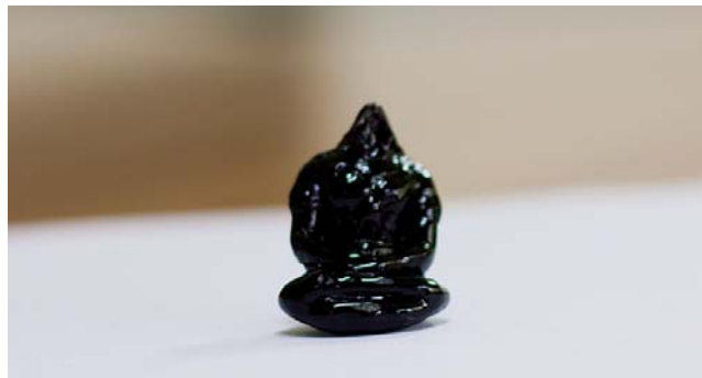
รูปที่ ก.1 อุณหภูมิในการอบแบบพิมพ์ไม่เหมาะสม
