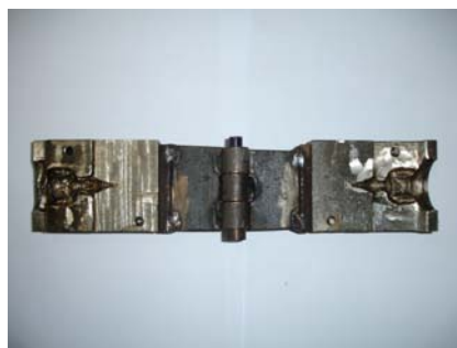
รูปที่ 3.5 แบบพิมพ์ด้านในสำหรับหล่อพระแก้วโกเมน
