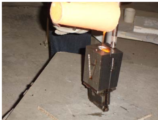
รูปที่ 3.25 การเทแก้วจากเบ้าลงในแบบพิมพ์พระ
