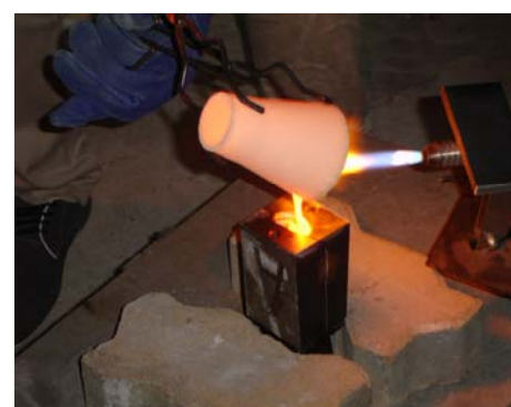
รูปที่ 3.28 การเทแก้วเหลวจากเบ้าลงแบบพิมพ์โดยใช้หัวเป่าฟั่นให้ความร้อน
