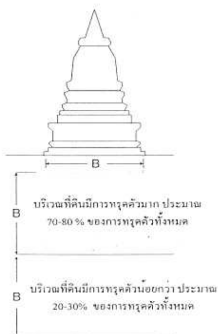
รูปที่ 5 การทรุดตัวของชั้นดินใต้ฐานรากดิน
