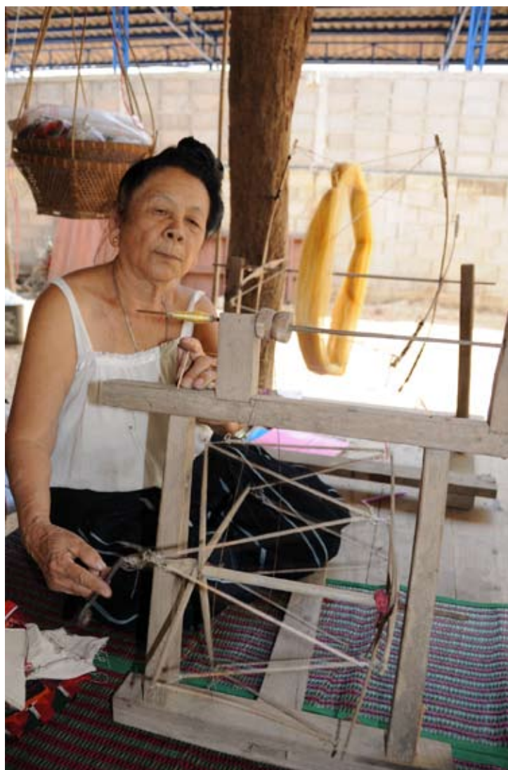
เอาเส้นไหมใยฝ้ายหรือด้ายไทเรมาใส่กง ไทดำเรียกว่า กงกว้าง นำมาปั่นด้วยจวงเพี้ยน (อุปกรณ์ปั่นด้ายเข้าหลอด)
