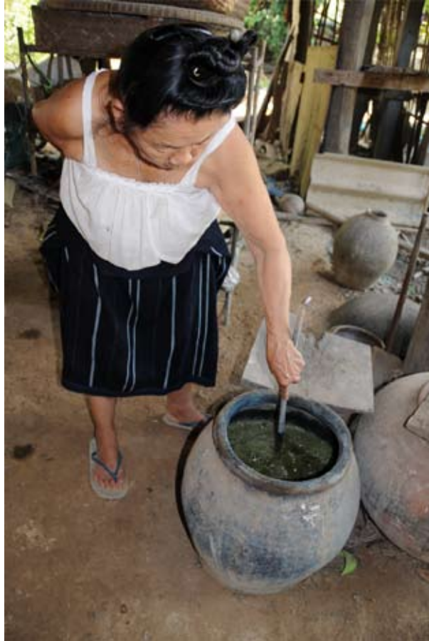
ใช้ปูนแดงผสมกับน้ำแช่ต้นคราม แกว่งให้ฟองแตก นำมากรอง
