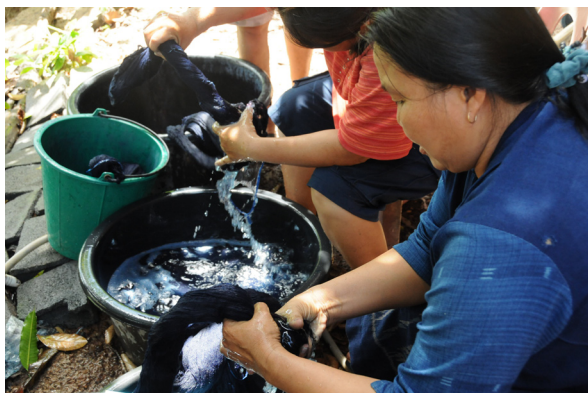
3) ย้อมในหม้อนิลประมาณ 5-7 นาที นำไปล้างน้ำให้สะอาด
