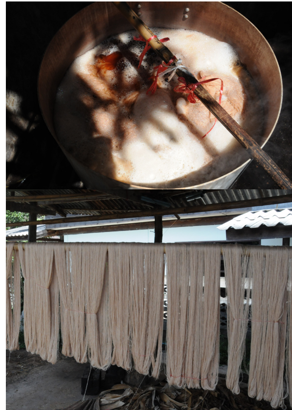
8) ใส่น้ำยาปรับผ้านุ่ม นำไปตาก (ทกเส้นฝ้ายเพื่อให้เส้นฝ้ายเรียบ)
