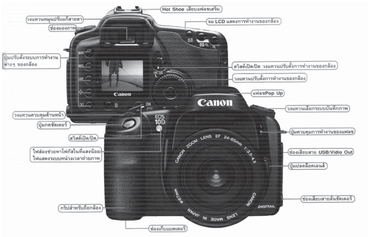
ส่วนต่าง ๆ ของกล้องดิจิตอลแบบซิงเกิลเลนส์รีเฟล็กซ์ (SLR Digital Camera)
