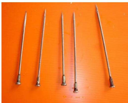
ภาพประกอบ 55 มีดตัดลายจะใช้ซี่รถจักรยานมาทำให้ปลายแหลมและมีคมทั้งสองด้าน เพื่อความคล่องตัวในการตัดลายดอกผึ้ง
