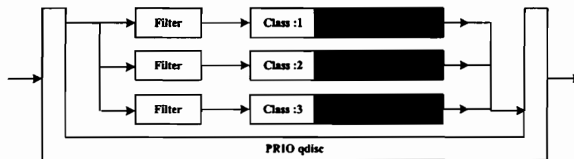
ภาพที่ 2.7 โครงสร้างของ PRIO qdisc
