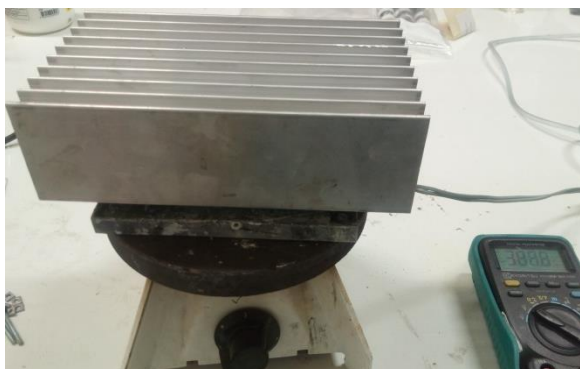
ภาพที่ 4.2 การจัดวางโมดูล 1 บนเครื่องทำความร้อน
