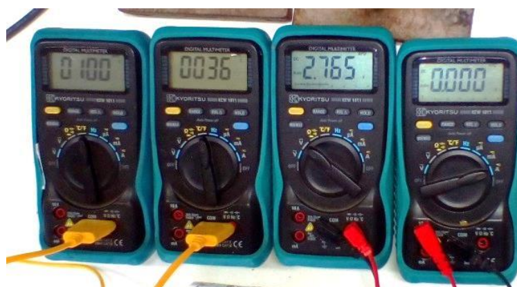
ภาพที่ 3.8 ดิจิตอลมัลติมิเตอร์ KYORITSU รุ่น KEW 1011 ใช้วัดสมบัติทางไฟฟ้าและอุณหภูมิ
