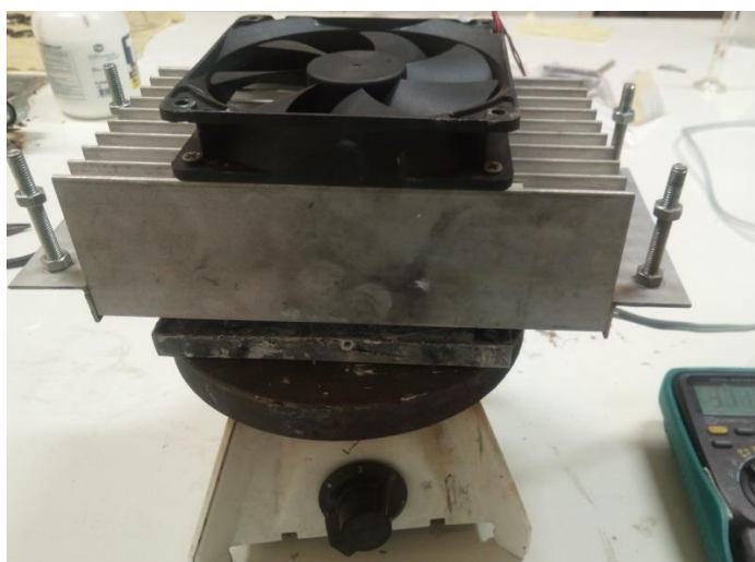
ภาพที่ 4.6 การจัดวางโมดูล 2 บนเครื่องทำความร้อน
