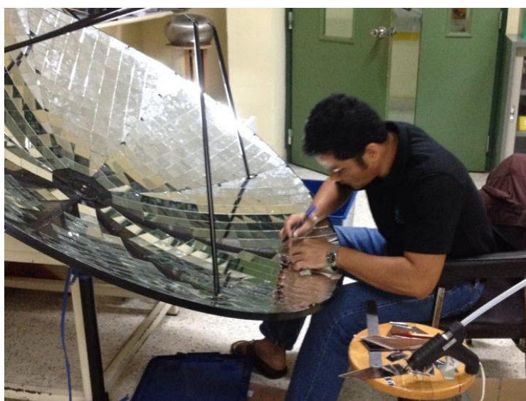
ภาพที่ 3.10 การติดตั้งแผ่นกระจกบนจานพาราโบลา
