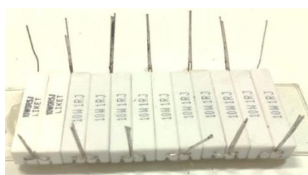
ภาพที่ 3.7 แผงความต้านทานอนุกรมขนาด 11 โอห์ม ใช้สำหรับทดสอบสมบัติทางไฟฟ้า
