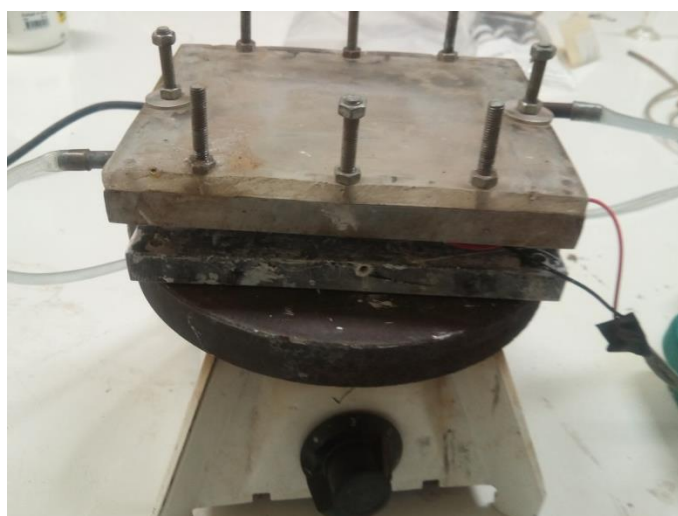
ภาพที่ 4.10 การจัดวางโมดูล 3 บนเครื่องทำความร้อน
