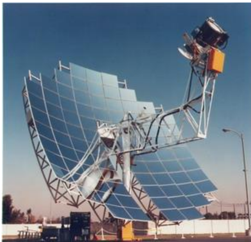
ภาพที่ 2.8 เครื่องยนต์สเตอร์ลิงผลิตไฟฟ้าโดยใช้การรวมแสงแบบจานพาราโบลา [1]
