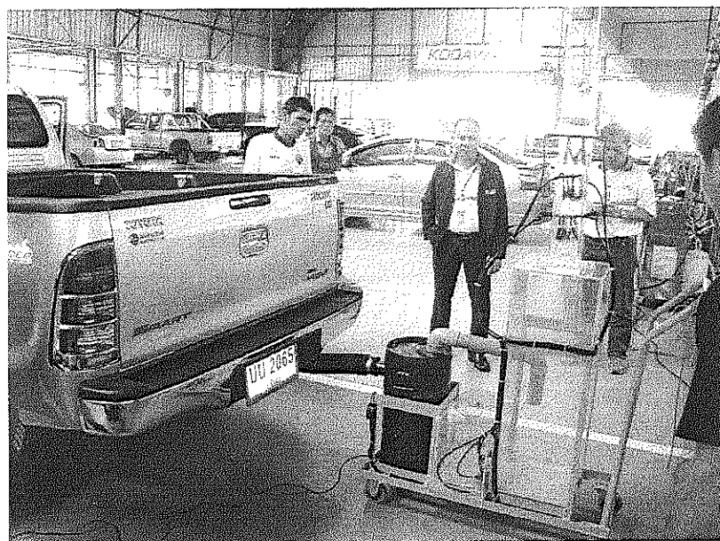
ภาพที่ 4.18 การทดสอบประสิทธิภาพการบำบัดควันไอเสียเครื่องยนต์ที่บริษัท โตโยต้าบุรีรัมย์ จำกัด
