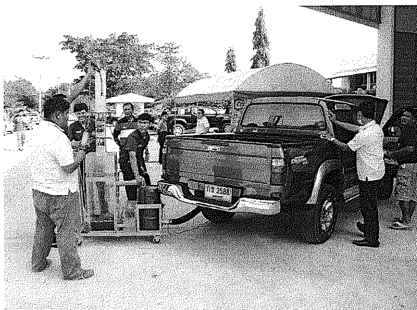
ภาพที่ 4.19 การทดสอบประสิทธิภาพการบำบัดควันไอเสียเครื่องยนต์ที่ขนส่งจังหวัดบุรีรัมย์
