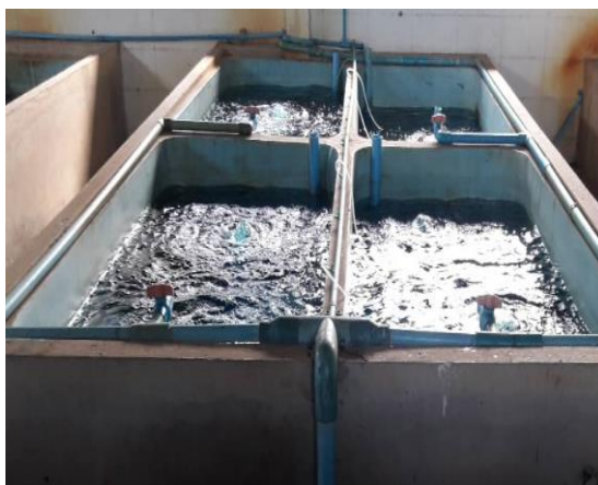
ภาพที่ 4.1 บ่อทดลองและระบบการให้อากาศระหว่างทดลอง
