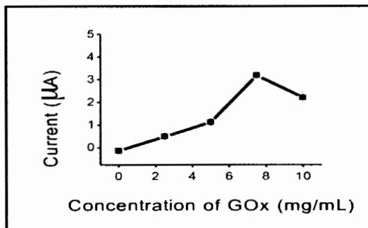
รูปที่ 6 ความสัมพันธ์ระหว่างค่ากระแสจากปฏิกิริยาออกซิเดชันของกลูโคส กับความเข้มข้นของเอนไซม์กลูโคสออกซิเดส (GOx)
