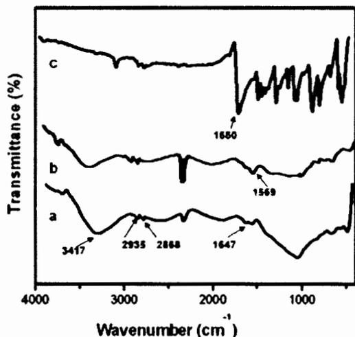
รูปที่ 1 แสดง FTIR spectra ของ MWCNTs-NH<sub>2</sub> (กราฟ a), MWCNTs-NH<sub>2</sub>-FcCHO (กราฟ b) และ FcCHO (กราฟ c)
