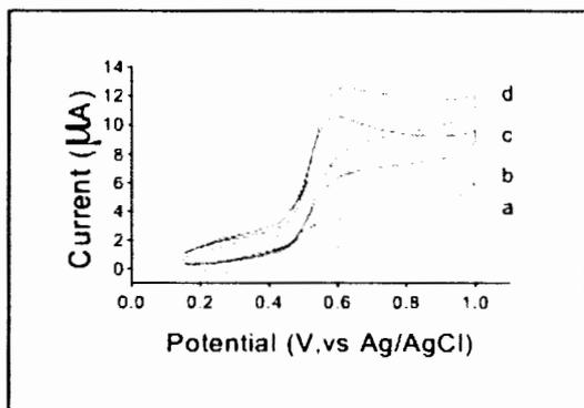
รูปที่ 2 แสดงไซคลิกโวลแทมโมแกรมของกลูโคส ความเข้มข้น (a) 0, (b) 5, (c) 10 และ (d) 15 มิลลิโมลาร์ ที่ขั้วกลูโคสไบโอเซนเซอร์ (GC/MWCNTs-NH<sub>2</sub>-FcCHO-BSA-GOx) ในสารละลายฟอสเฟตบัฟเฟอร์ เข้มข้น 0.1 โมลาร์ พีเอช 7.0 (ภายใต้บรรยากาศก๊าซอาร์กอน)
