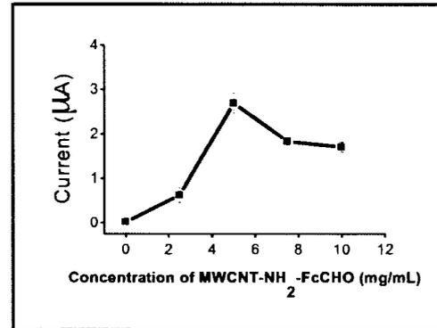
**รูปที่ 5** ความสัมพันธ์ระหว่างค่ากระแสจากปฏิกิริยาออกซิเดชันของกลูโคสกับความเข้มข้นของวัสดุเชิงประกอบ MWCNTs-NH<sub>2</sub>-FcCHO ที่ใช้ในการตัดแปรกลูโคสไบโอเซนเซอร์
