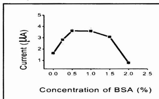
รูปที่ 7 ความสัมพันธ์ระหว่างค่ากระแสจากปฏิกิริยาออกซิเดชันของกลูโคส กับความเข้มข้นของสารละลายโบวีนซีรัมอัลบูมิน (BSA) ที่ใช้ในการเตรียมกลูโคสไบโอเซนเซอร์
