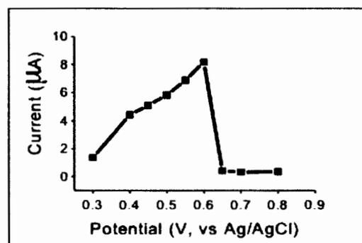
รูปที่ 8 ความสัมพันธ์ระหว่างค่ากระแสจากปฏิกิริยาออกซิเดชันของกลูโคสกับศักย์ไฟฟ้าที่ให้แกขั้วกลูโคสไบโอเซนเซอร์ในระบบโพลีอินเจคชัน
