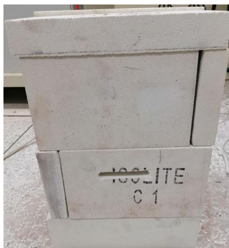
ภาพที่ ก.2 เตาความร้อนเมื่อเพิ่มชั้นฉนวนอิฐทนไฟเพื่อป้องกันความร้อน
