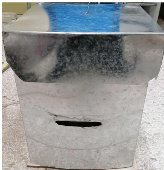
ภาพที่ ก.3 เตาความร้อนเมื่อเพิ่มชั้นสังกะสีเพื่อป้องกันการสูญเสียความร้อน
