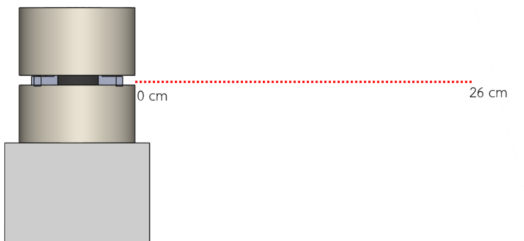
ภาพที่ 3.18 การวัดอุณหภูมิภายนอก Block heater
