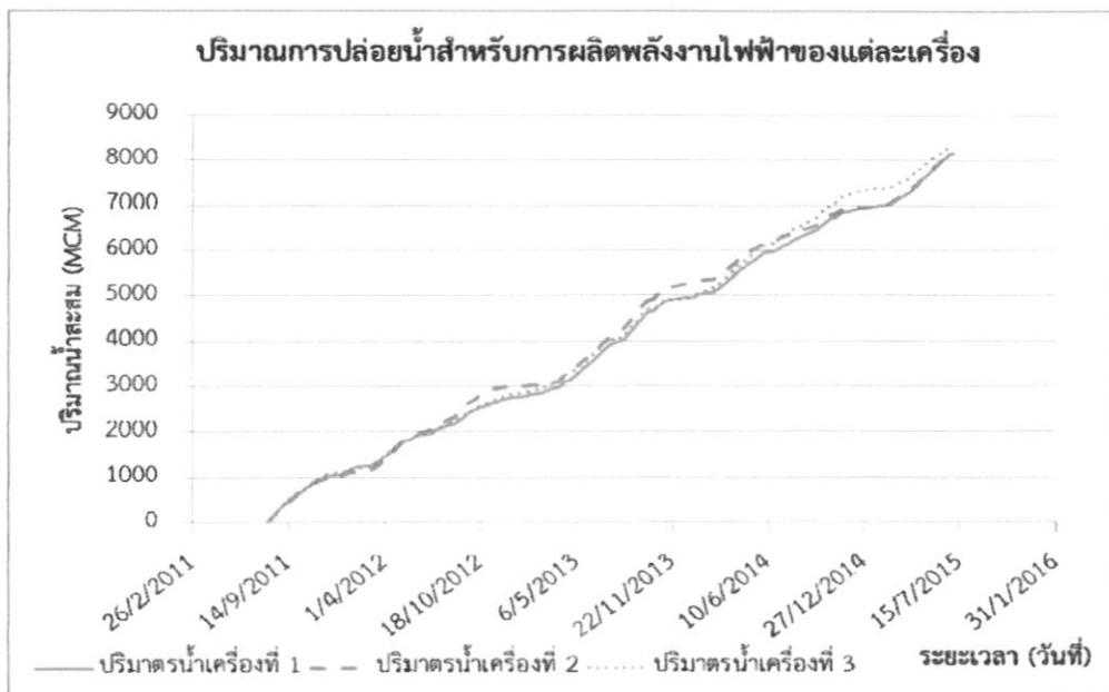
ภาพที่ 4.1 ปริมาณการปล่อยน้ำสำหรับการผลิตพลังงานไฟฟ้าของเครื่องกำเนิดไฟฟ้าแต่ละเครื่อง
