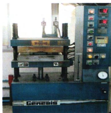
ภาพที่ 3.3 เครื่องอัดไฮดรอลิก (Compression moulding machine)
