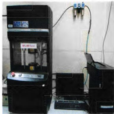
ภาพที่ 3.2 เครื่อง Moving die rheometer (MDR)
