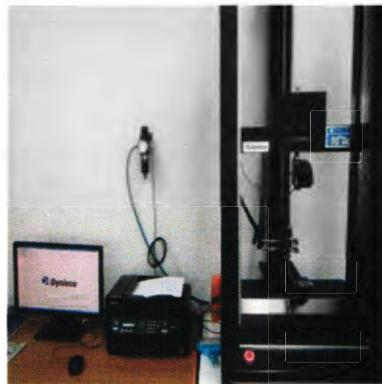
ภาพที่ 3.6 เครื่อง Universal tensile tester
