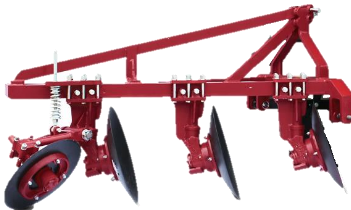
ภาพที่ 2.2 แสดงลักษณะของไตรจานสาม ที่มา: Yanmar (2019)
