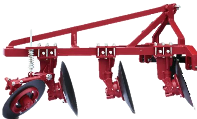
ภาพที่ 3.2 จานไถเป็นแบบมาตรฐาน (Standard disk plow)
