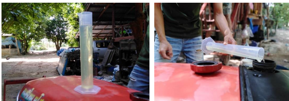
ภาพที่ 6.4 การวัดปริมาณน้ำมันเชื้อเพลิง
