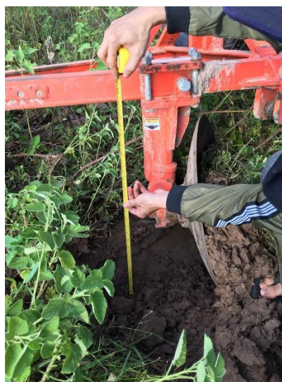
ภาพที่ 2.5 การวัดความลึกหลังการไถดิน
