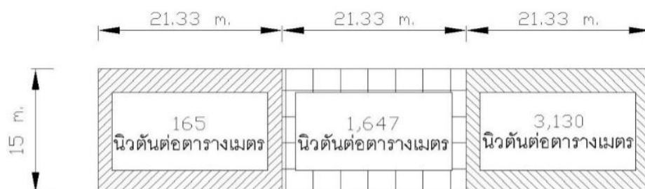
ภาพที่ 3.27 แรงลมสุทธิที่กระทำกรณีที่ขอบป้ายด้านขวาชี้เข้าหาลม
