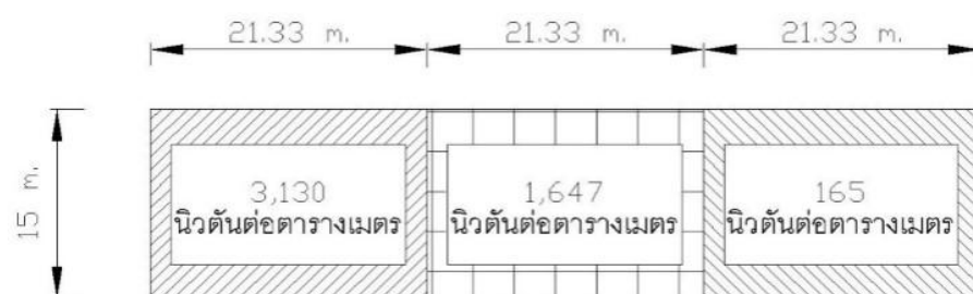
ภาพที่ 3.26 แรงลมสุทธิที่กระทำกรณีที่ขอบป้ายด้านซ้ายชี้เข้าหาลม
