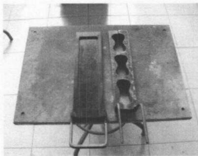
ภาพที่ 3.14 แบบโลหะสำหรับขึ้นรูปชิ้นงาน
