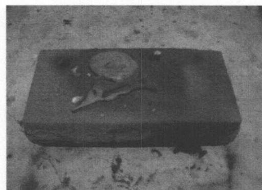
**ภาพที่ 4.9** แบบหล่อทรายหลังจากเทหล่อน้ำโลหะ ที่ส่วนผสมฟีโนลิกเรชิน 6.5%
