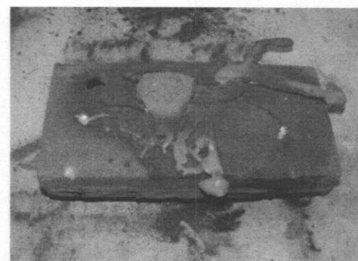
**ภาพที่ 4.10** แบบหล่อทรายหลังจากเทหล่อน้ำโลหะ ที่ส่วนผสมฟีโนลิกเรชิน 8.5%
