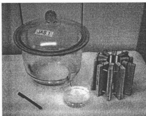
ภาพที่ 2.15 วิธีการทดสอบแบบ Desiccator มาตรฐาน JIS และ JAS
