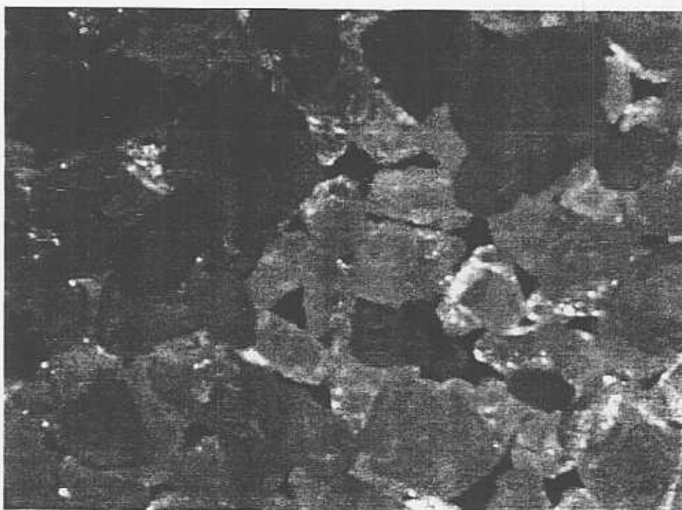
รูปที่ 4.3 ทราขนาคเบอร์30 ที่ตกค้างบนเบอร์40คูผ่านกล้องเสดอริโอไมโครสโคป กำลังขยาย 60 เท่า
