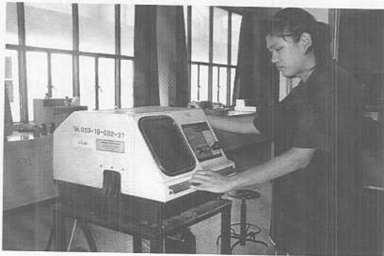
รูปที่ 3.1 เครื่องตัดเตรียมตัวอย่างเพื่อศึกษาโครงสร้างจุลภาค ชื่อ BUEHLER ABRASIMET2
