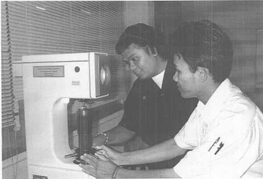
รูปที่ 3.4 เครื่องทดสอบความแข็ง แบบ Rockwell scale hardness tester model AR-10 Mitutoyo
