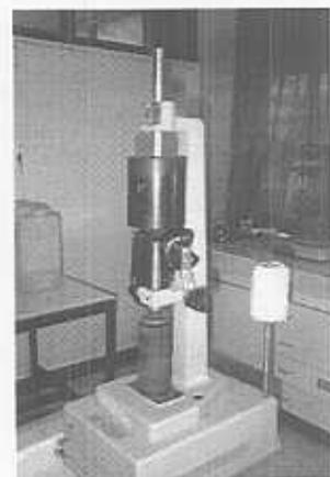
รูปที่ 3.8 เครื่อง Standard sand rammer
