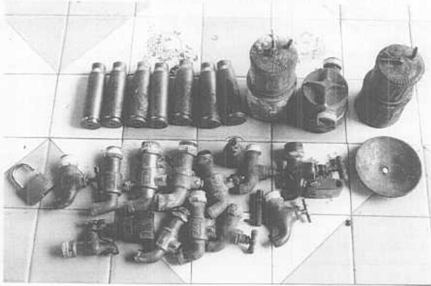
รูปที่ 4.1 เศษโลหะประเภททองเหลือง ที่นำมาใช้ในहारหลอมหล่อ
