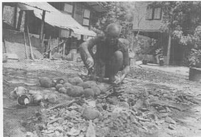
รูปที่ 2.23 การแกะแบบ โดยทุบด้วยค้อนให้แบบแตก แยกเอาเฉพาะชิ้นงานหล่อนำไปทำความสะอาด และตกแต่งในขั้นตอนนี้ต่อไป
