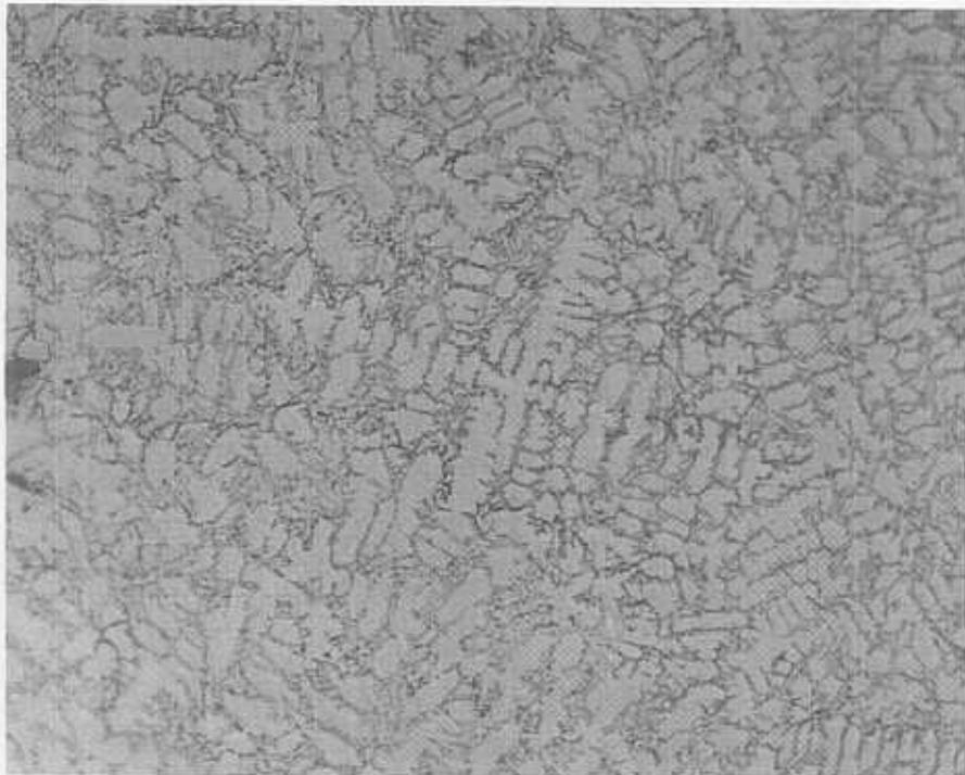
รูปที่ 4.6 โครงสร้างจุลภาคของข้อต่อทองเหลืองกำลังขยาย 100 เท่า
