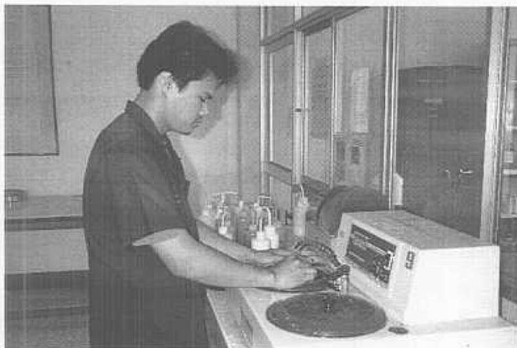
รูปที่ 3.2 เครื่องขัดเตรียมผิวโลหะ Grinder – Polishers บี่ห้อ BUEHLER-METASERV
