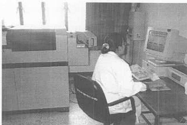
ที่ 3.14 วิเคราะห์หาส่วนผสมทางเคมี Spectrometer ซีทีอ Applied Research Laboratories ARL
