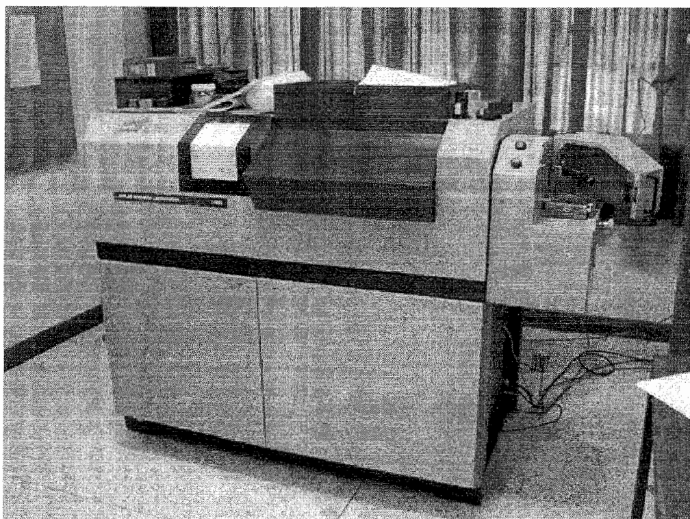
ภาพที่ 4.2 เครื่อง Spectrometer ที่ใช้ในการวิเคราะห์หาส่วนประกอบทางเคมีของเหล็กที่ใช้ในการทดลอง
