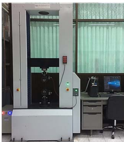
ภาพที่ 2.7 เครื่องทดสอบเอนกประสงค์ รุ่น NRI-TS501-300
