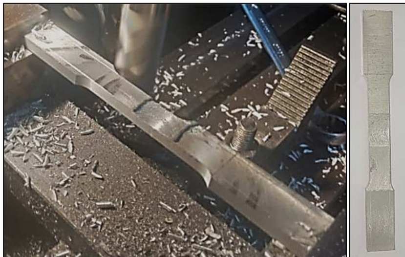
ภาพที่ 3.9 ชิ้นงานทดสอบแรงดึงตามมาตรฐาน ASTM E8-04
