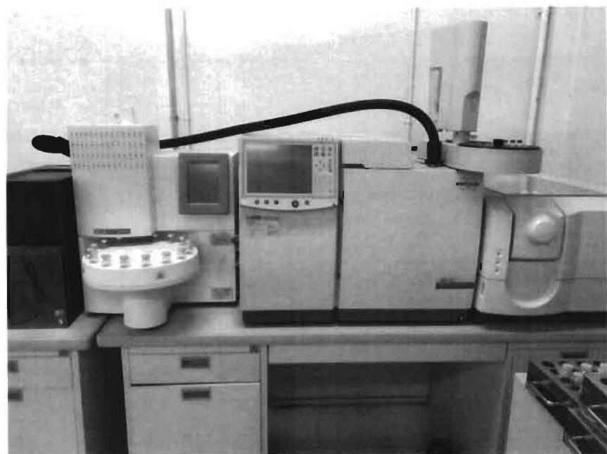
ภาพที่ 3.4 เครื่องแก๊สโครมาโตแกรม (gas chromatogram หรือ GC) ยี่ห้อ Bruker's รุ่น 450-GC (Netherlands) และเครื่อง Headspace sampler ยี่ห้อ Perkin Elmer รุ่น Terbomatrix 16 (Singapore)
