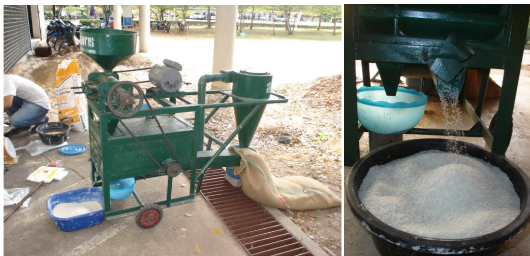
รูปที่ 3.15 (ซ้าย) เครื่องสีข้าวขนาดเล็กที่ใช้ในการทดสอบ และ (ขวา) ข้าวสารที่ได้จากการสี
