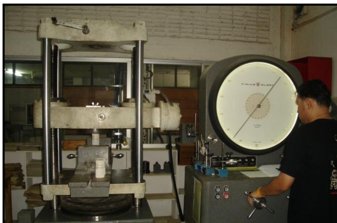
รูปที่ 3.13 เครื่อง ทดสอบแรงอัด ภาควิชาโยธา คณะวิศวกรรมศาสตร์ มหาวิทยาลัยเทคโนโลยีราชมงคลธัญบุรี วิทยาเขตภาคพายัพ จังหวัดเชียงใหม่ ที่ใช้ในการทดสอบ
