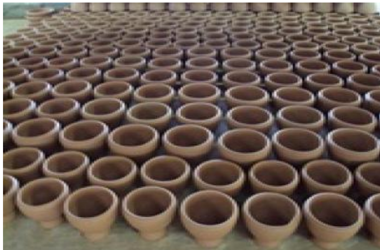
ภาพที่ 4.5 พื้นที่ตากผลิตภัณฑ์โดยการเผื่องมที่เป็นแบบวางพื้น
