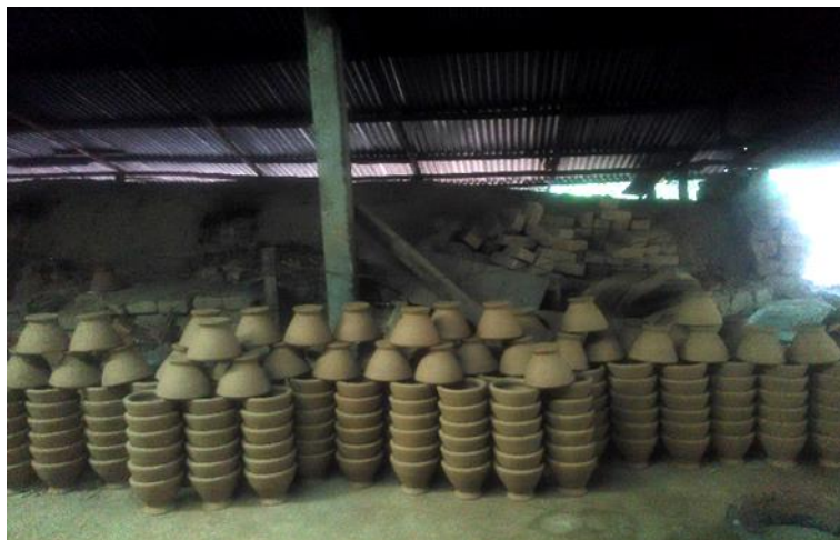
ภาพที่ 4.5 พื้นที่ตากผลิตภัณฑ์โดยการเผื่องมที่เป็นแบบวางพื้น
