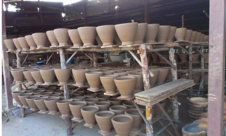
ภาพที่ 4.4 พื้นที่ส่วนการเผื่องมที่เป็นแบบชั้น เพื่อประหยัดพื้นที่
