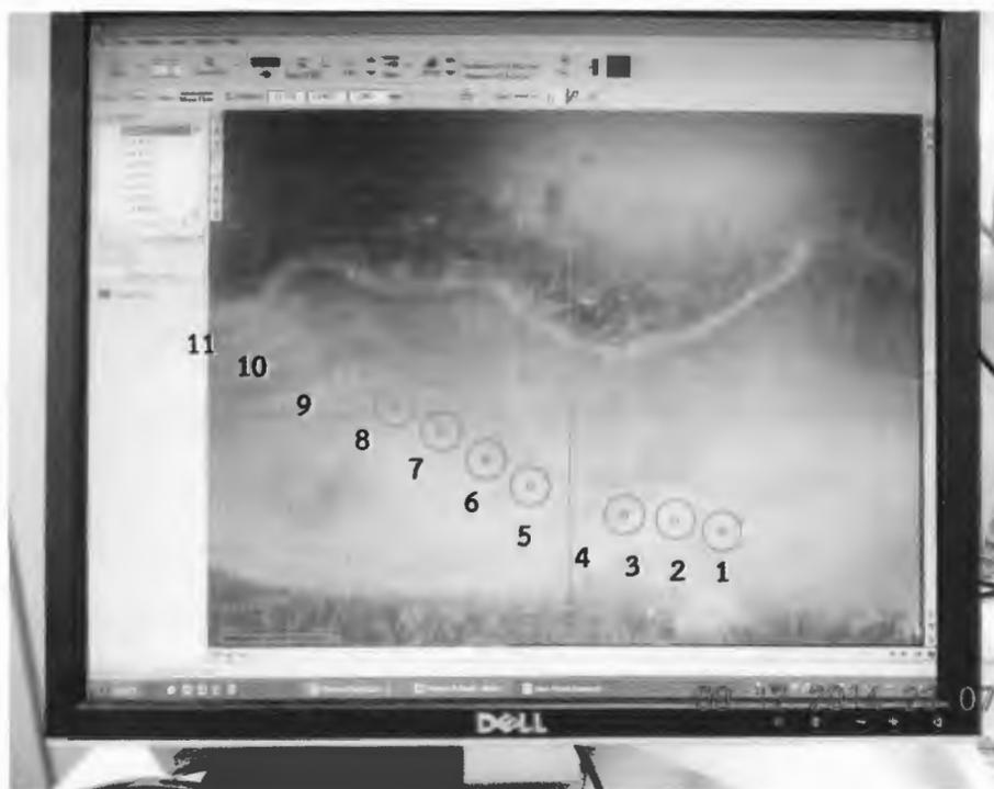
ภาพที่ 5.5 การตั้งค่าการยิงลำแสงเลเซอร์เป็นจุด (spot) เริ่มตั้งแต่แก่นกลางกระดูกหูด (Primodium/core) เป็นแนวยาวเรื่อยไปจนถึงพื้นที่ขอบกระดูกหูด
