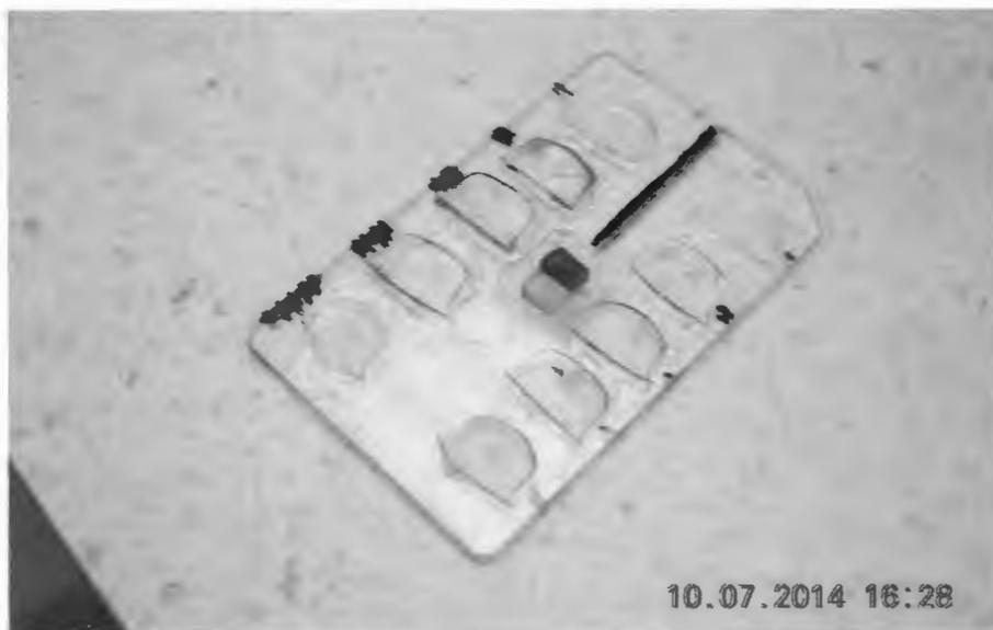
ภาพที่ 5.4 การจัดวางตัวอย่างชิ้นส่วนของกระดูกหูดคขวาง (ซึ่งฝังอยู่ในเรซิน) บนสไลด์แก้วเพื่อการวิเคราะห์ธาตุด้วยเครื่องมือวิเคราะห์ธาตุ (ICP-MS: inductively coupled plasma mass spectrometer) วัสดุอ้างอิงมาตรฐาน NIST 612 และ NIST 610 ถูกจัดวางไว้บริเวณกึ่งกลางสไลด์แก้ว
