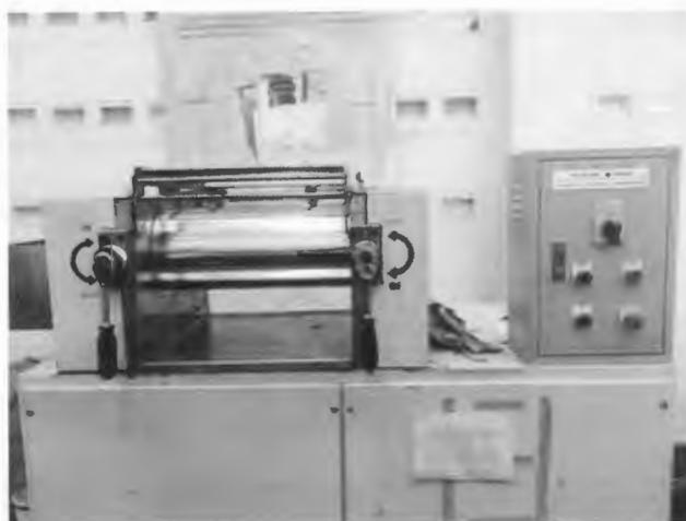
รูปที่ 2.4 ลักษณะเครื่อง Tow-Roll-Mill
