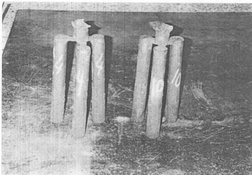
รูปที่ 3.2.3 ชิ้นตัวอย่างที่ได้เมื่อหล่อเสร็จ
