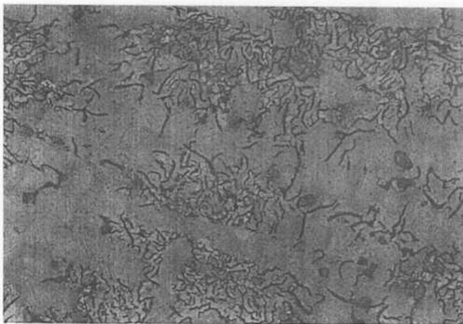
รูปที่ 4.7.8 ตัวอย่างชิ้นงาน ก่อนกัดกรด 3 % Nital กำลังขยาย X 100
