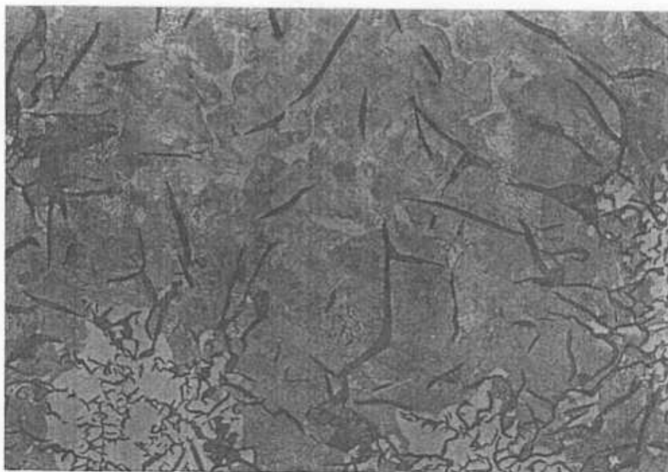
รูปที่ 4.7.6 ตัวอย่างชิ้นงาน ก่อนกันกรด 3 % Nital กำลังขยาย X 500
