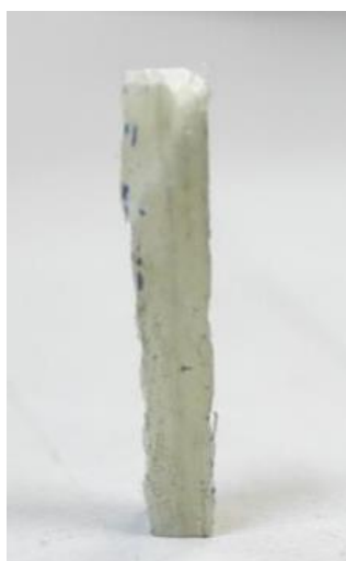
ภาพที่ 3.44 ชิ้นงานที่มีการเรียงตัวของเส้นใยตามแนวขวางของชิ้นงานสำหรับการทดลองแรงกด
