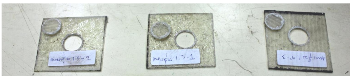
ภาพที่ 3.51 ชิ้นงานที่มีการเรียงตัวของเส้นใยแบบสุ่มหลายทิศทางของชิ้นงานสำหรับการทดลองแรงเฉือน
