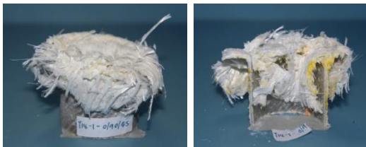
รูปที่ 11 การเสียหายสุดท้ายของชิ้นงาน C ภายใต้ภาระกระทำกึ่งคงที่
