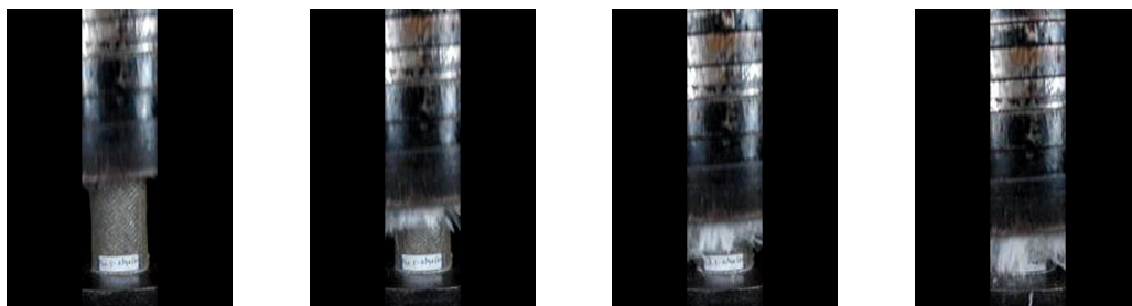
ภาพที่ 4.14 การเสียหายของชิ้นงานภายใต้แรงกระทำของชิ้นงาน C
