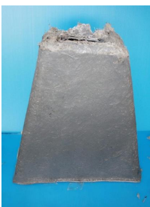
ภาพที่ 4.30 การเสียหายสุดท้ายของชิ้นงานภายใต้แรงกระแทกในแนวแกนของชิ้นงานที่มีมุมเอียง แตกต่างกันและความหนาคือ 2.5 mm (ก) ชิ้นงาน A5-2.5 (ข) ชิ้นงาน B10-2.5 และ (ค) ชิ้นงาน C15-2.5 ตามลำดับ
