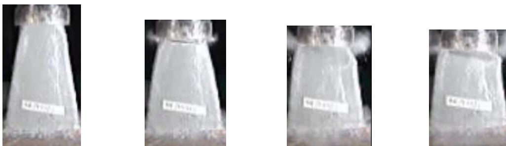
ภาพที่ 4.27 การเสียหายภายใต้แรงกระทำในแนวแกนของชิ้นงานที่มีมุมเอียงแตกต่างกันและความหนาคือ 2.0 mm (ก) ชิ้นงาน A5-2.0 และ (ข) ชิ้นงาน B10-2.0
