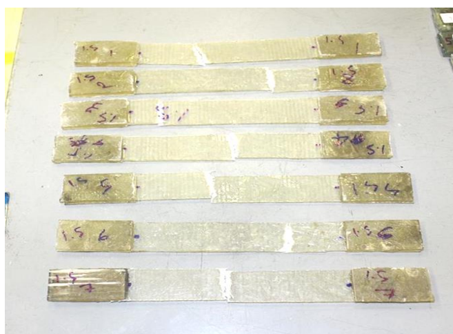
ภาพที่ 3.35 ชิ้นงานที่มีการเรียงตัวของเส้นใยแบบสุ่มหลายทิศทาง สำหรับการทดลองแรงดึง
