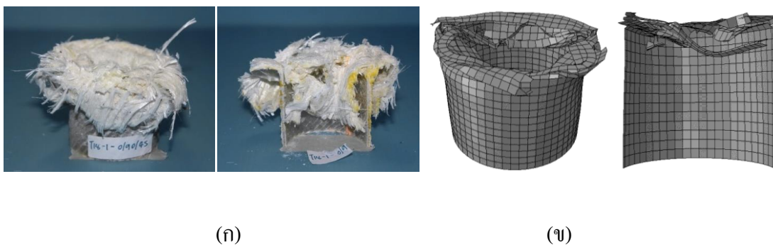
ภาพที่ 4.6 การเสียหายสุดท้ายของชิ้นงาน C ภายใต้แรงกึ่งคงที่ (ก) การทดลอง (ข) แบบจำลองทาง FEA
