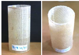
รูปที่ 2 แสดงถึงชิ้นงานที่ได้จากการขึ้นรูป
