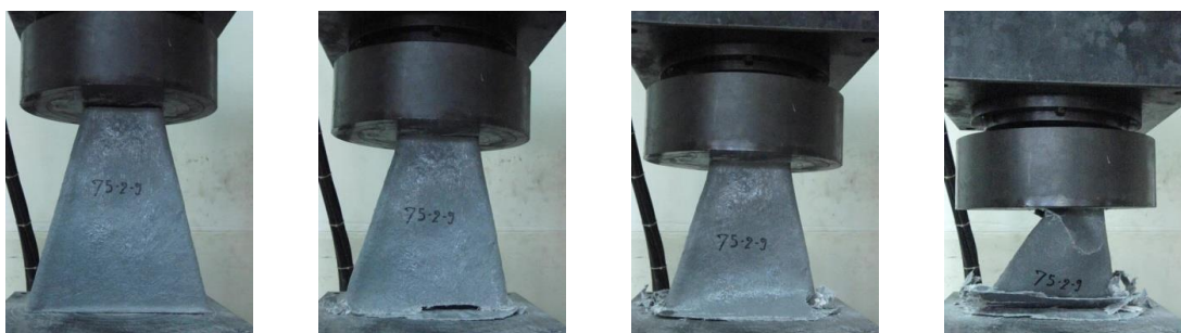
ภาพที่ 4.19 การเสียหายภายใต้ภาระกระทำในแนวแกนแบบกึ่งคงที่ของชิ้นงานที่มีมุมเอียงแตกต่างกันและความหนาคือ 1.5 mm (ก) ชิ้นงาน A5-1.5 (ข) ชิ้นงาน B10-1.5 และ (ค) ชิ้นงาน C15-1.5 ตามลำดับ
