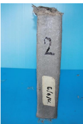
ภาพที่ 4.30 การเสียหายสุดท้ายของชิ้นงานภายใต้แรงกระแทกในแนวแกนของชิ้นงานที่มีมุมเอียง แตกต่างกันและความหนาคือ 2.5 mm (ก) ชิ้นงาน A5-2.5 (ข) ชิ้นงาน B10-2.5 และ (ค) ชิ้นงาน C15-2.5 ตามลำดับ
