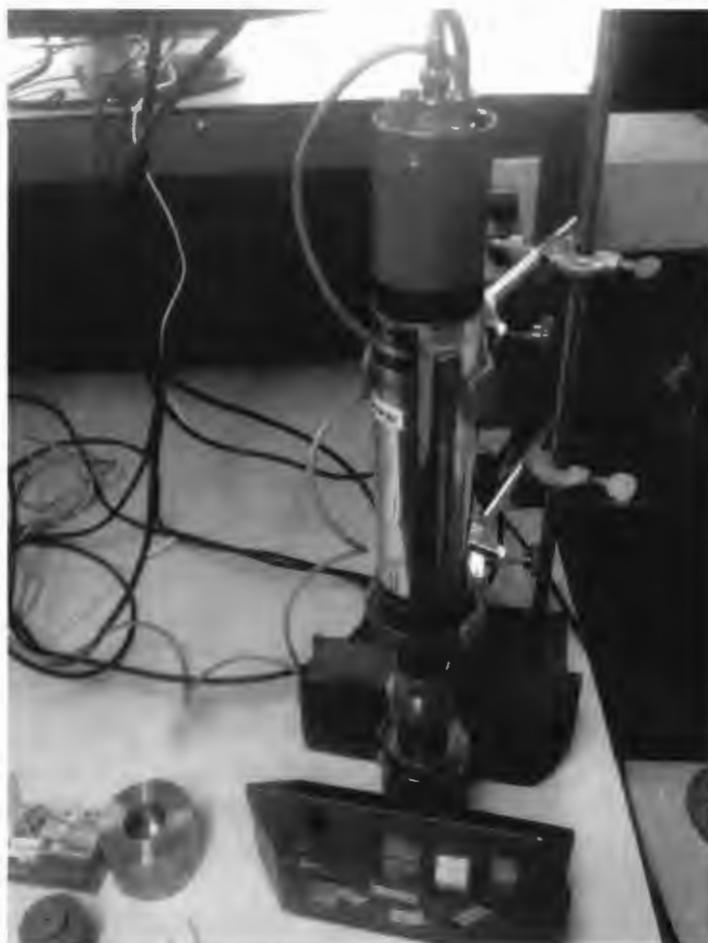
ภาพที่ ก.17 การจัดอุปกรณ์สำหรับการวัดสมบัติทางรังสีด้วยวิธี Narrow beam transmission
