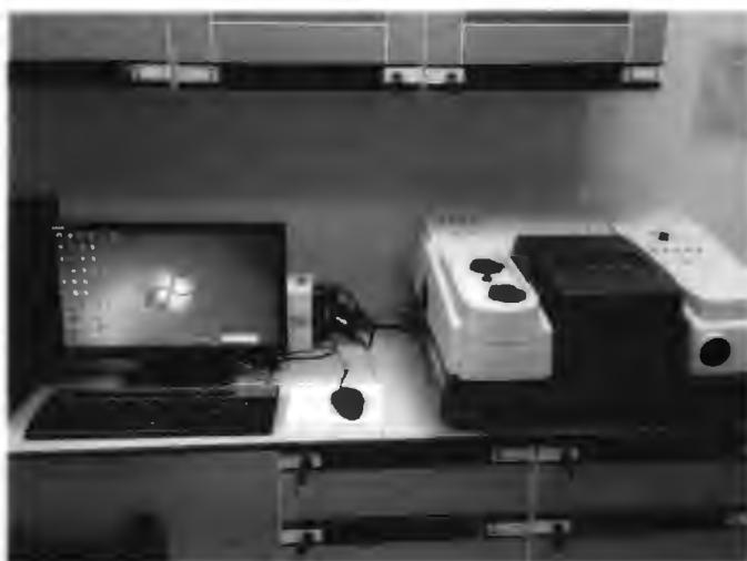
ภาพที่ ก.11 เครื่อง FTIR Spectrometer ยี่ห้อ Thermo Scientific รุ่น Nicolet 6700
