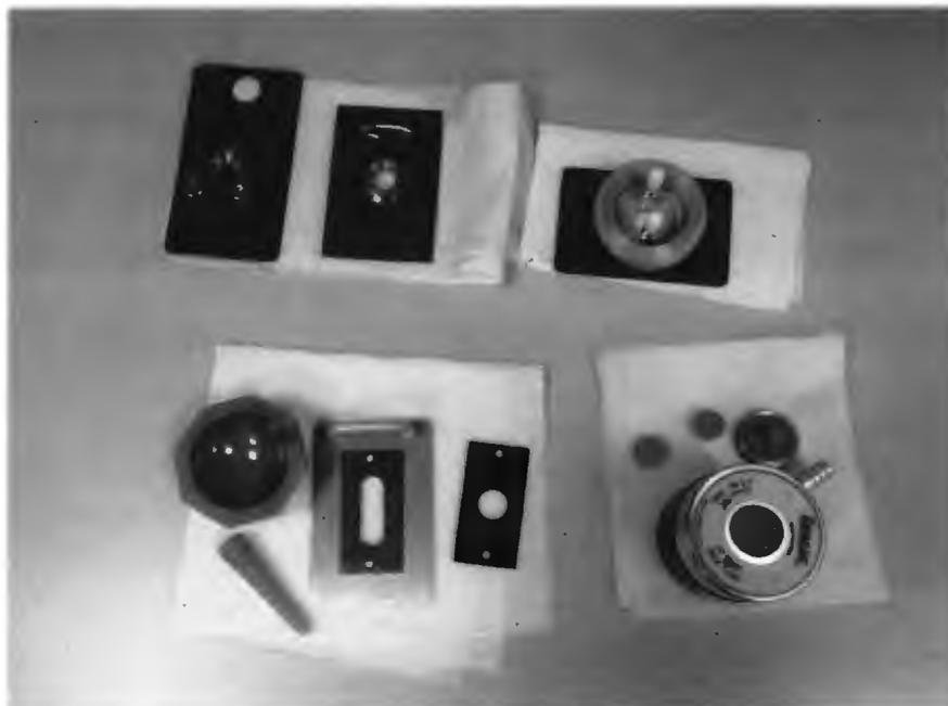
ภาพที่ ก.13 ชุดอุปกรณ์สำหรับเตรียมตัวอย่างเพื่อวิเคราะห์ FTIR
