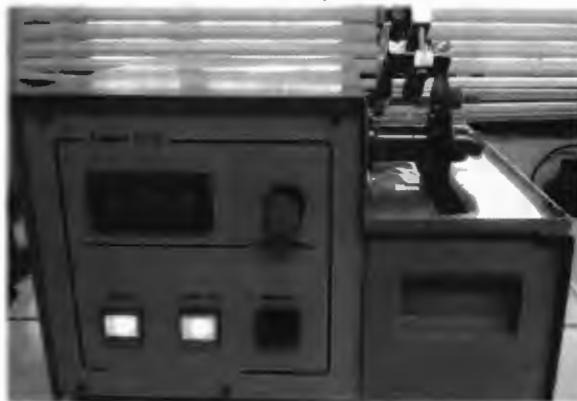
ภาพที่ ก.7 เครื่องตัดชิ้นงาน ยี่ห้อ Benetec limited รุ่น labcut 1010
