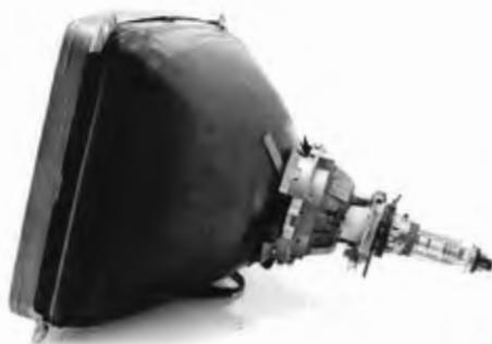
ภาพที่ 2.6 ลักษณะหลอดรังสีแคโทด (CRT) ของคอมพิวเตอร์ [18]
