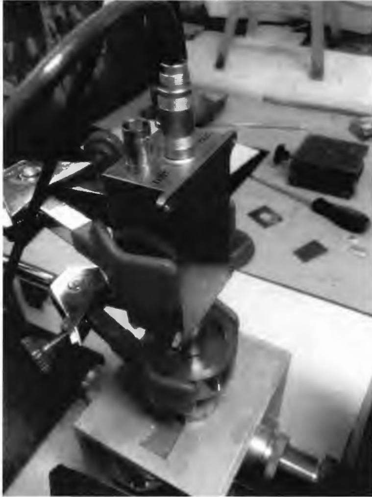
ภาพที่ ก.19 การจัดอุปกรณ์สำหรับการวัดสมบัติทางรังสีด้วยวิธี Narrow beam transmission method แบบ secondary target
