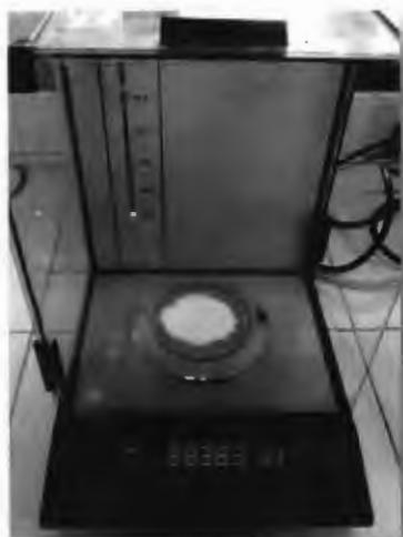
ภาพที่ ก.1 เครื่องชั่งอิเล็กทรอนิกส์ ยี่ห้อ Denver Instrument ความละเอียด 0.0001 กรัม
