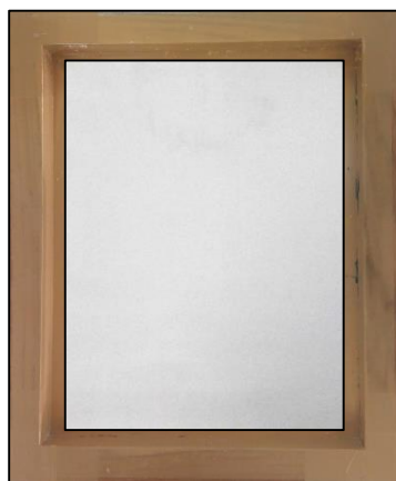
ภาพที่ 3.3 กรอบไม้สี่เหลี่ยมสำหรับติดผ้าสกรีน
