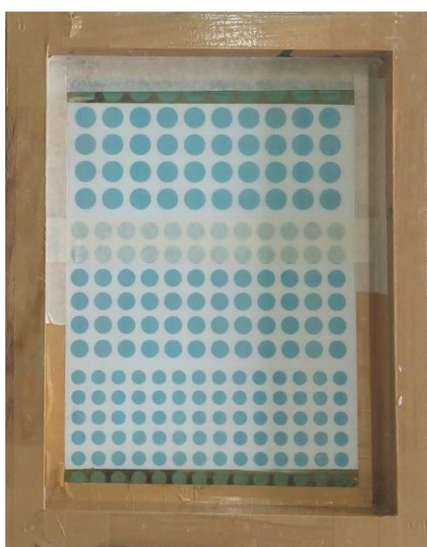
ภาพที่ 3.4 บล็อกสกรีนแบบพิมพ์รูปวงกลม
