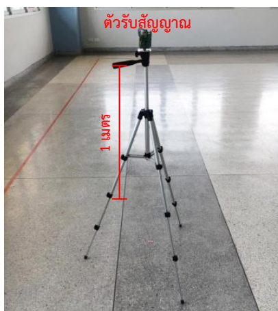
ภาพที่ 4.12 ลักษณะการวางของตัวรับสัญญาณ
