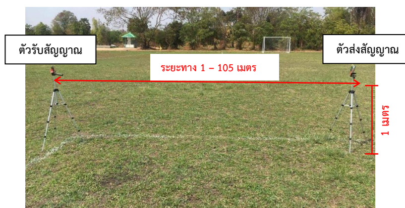
ภาพที่ 4.6 การทดลองหาค่าความคลาดเคลื่อนของตัวส่งสัญญาณแต่ละตัวที่ระยะทางต่าง ๆ
