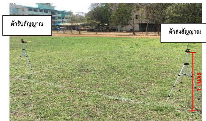
ภาพที่ 4.5 การทดลองระยะการทำงานของบอร์ดอัลตราไวด์แบนด์
