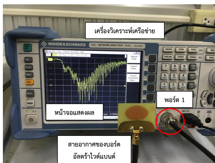
ภาพที่ 4.3 การทดลองวัดค่าสัมประสิทธิ์การสะท้อน
