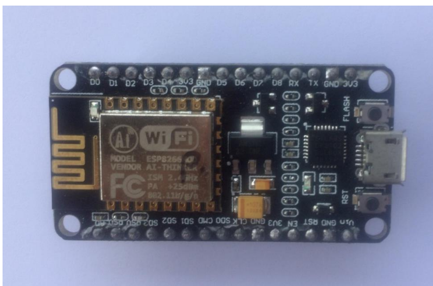
ภาพที่ 2.9 บอร์ดไมโครคอนโทรลเลอร์ที่มีไอซี ESP - 8266 เป็นส่วนประกอบ
