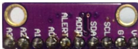
ภาพที่ 2.8 ตัวแปลงสัญญาณอนาลอกเป็นดิจิตอล ADS 1115
