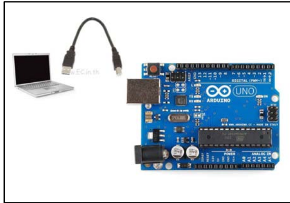
ภาพที่ ข.31 การเชื่อมต่อบอร์ด Arduino เข้ากับคอมพิวเตอร์ผ่านทางพอร์ต USB
