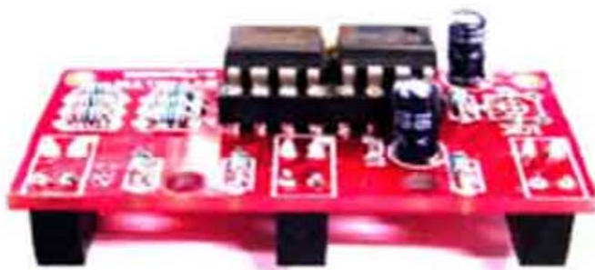
ภาพที่ 2.20 วงจรสำหรับตรวจจับเส้นขนาด 1 จุด (Tractor Circuit)
