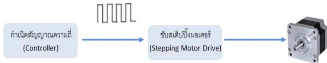
ภาพที่ 2.16 แผนผังการทำงานของ Stepping Motor
