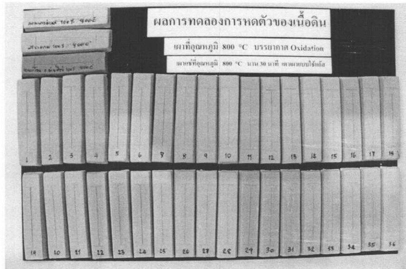
ภาพที่ 13 ผลการทดลองการหดตัวของเนื้อดินหลังเผาที่อุณหภูมิ 800 องศาเซลเซียส
