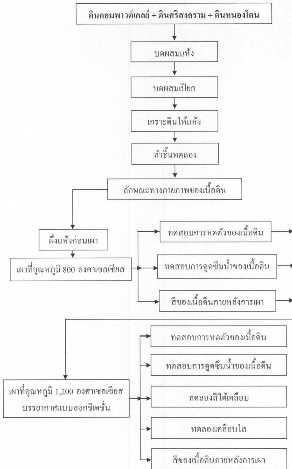
ภาพที่ 1 แผนภูมิแสดงกระบวนการทดลองคุณสมบัติของเนื้อดิน
