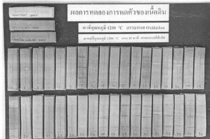
ภาพที่ 14 ผลการทดลองการหดตัวของเนื้อดินหลังเผาที่อุณหภูมิ 1,200 องศาเซลเซียส
