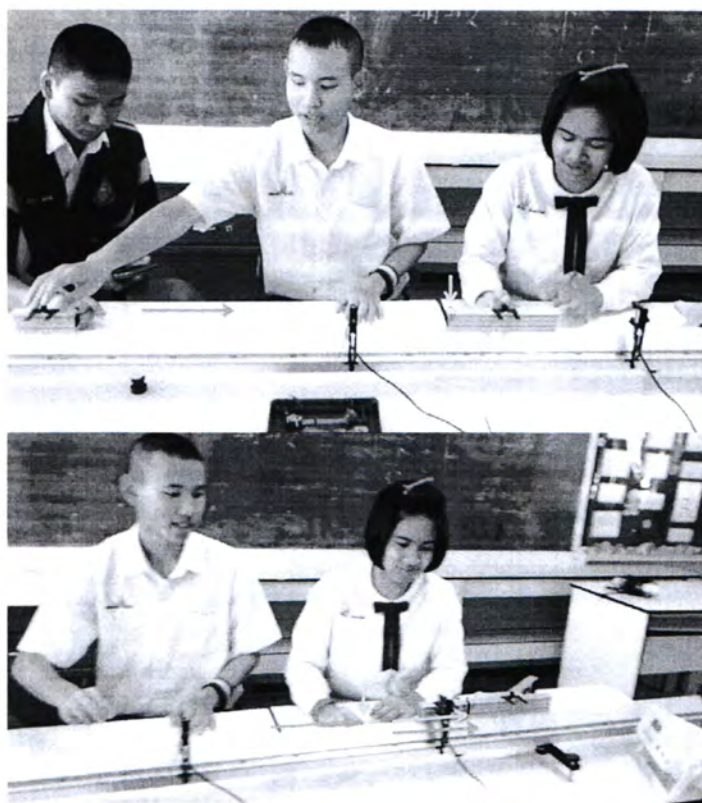
ภาพที่ ๕.5 นักเรียนทำการทดลองที่ 4 เรื่องการชนใน 1 มิติ แบบไม่ยืดหยุ่น
