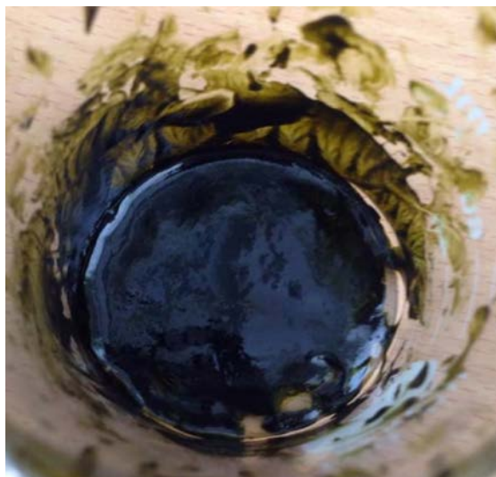
ภาพที่ 4.1 ตัวอย่างของไขมันสกัดจากใบกะหล่ำปลีด้วยวิธีชอกท์เลตและมีการปนเปื้อนของไขมันด้วยสารอื่น ๆ เช่น คลอโรฟิลล์ ที่ให้สีเขียวในใบกะหล่ำปลี
