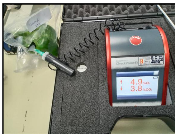
ภาพที่ 13 เครื่องวัดแก๊ส \text{O}_2 และ แก๊ส \text{CO}_2 Handheld gas analyser รุ่น Checkpoint3 (PBI. Dansensor, Denmark) (ได้รับความเอื้อเฟื้อจากห้องปฏิบัติการเทคโนโลยีพลาสติก ศูนย์เทคโนโลยีโลหะและวัสดุแห่งชาติ)
