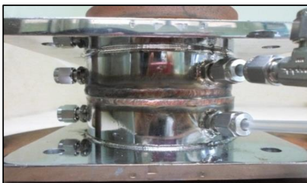
ภาพที่ 10 stainless steel cell ใช้ในการวัด film permeability to ethanol vapour (FPE) ที่มา: พชรี มะลิลา (2559; อ้างอิงจาก Utto, 2008)
