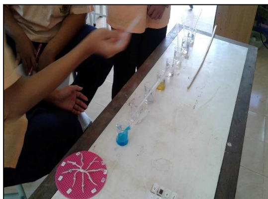
ฉ.3 ขั้นตอนการหยดสารละลายอิเล็กโทรไลต์ลงบนเส้นด้าย
