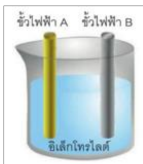
ภาพที่ 2.1 ขั้วไฟฟ้า A และขั้วไฟฟ้า B สัมผัสกับอิเล็กโทรไลต์ชนิดเดียวกัน ไม่มีสะพานเกลือ ที่มา: สถาบันส่งเสริมการสอนวิทยาศาสตร์และเทคโนโลยี (2556: 24)
