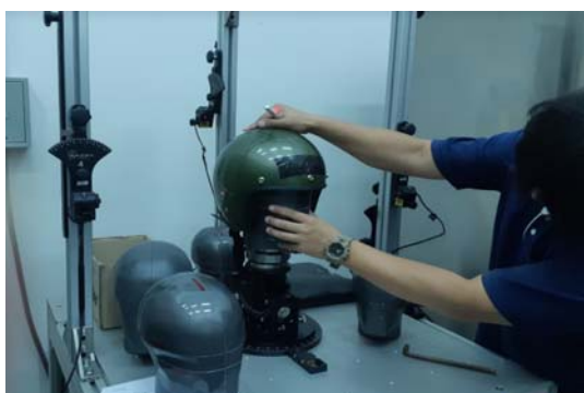
ภาพที่ 3.16 การเช็คจุดที่จะทำการกระแทก
