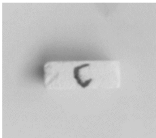
(ข) การเตรียมชิ้นงานในการทดสอบหาคุณสมบัติเชิงกลของโฟมหอยก้นน็อค
