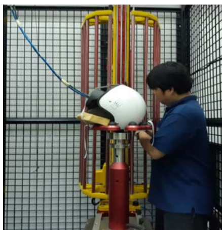
ภาพที่ 3.17 การปรับให้ศีรษะจำลองที่สวมหมวกทำการกระแทกที่มุม 35^\circ
