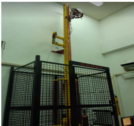
ภาพที่ 3.18 เครื่องทดสอบยกหมวกขึ้นไปให้ได้ความสูง 3 เมตร
