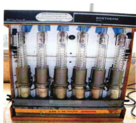
**ภาพที่ 3** อุปกรณ์วิเคราะห์โภชนา (ซ้ายชุดอุปกรณ์วิเคราะห์โปรดีน, ขวาชุดอุปกรณ์วิเคราะห์ไขมัน)
