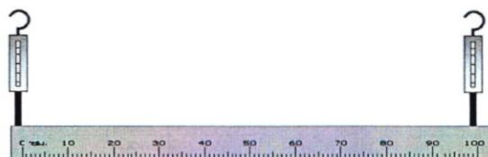
2. อ่านค่าเครื่องชั่งสปริงแต่ละข้างจากบันทึกไว้ (โดยค่าที่อ่านได้เป็นค่าน้ำหนักของไม้เมตร)
