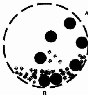
ภาพที่ 15 การบดย่อยด้วยลูกบอล โดยอาศัยการหมุน
