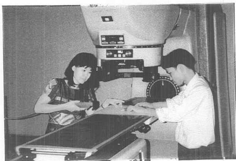
รูปที่ 3.2.4 แสดงเครื่องฉายรังสีแกรมนาที่ใช้ทดสอบคุณสมบัติทางรังสี
