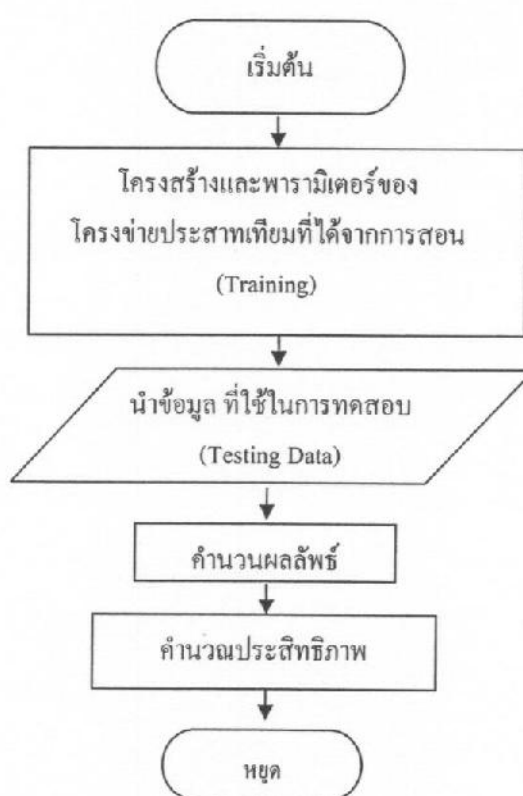
ภาพที่ 3.9 แผนผังการทดสอบโครงข่ายประสาทเทียม (Testing Process)
